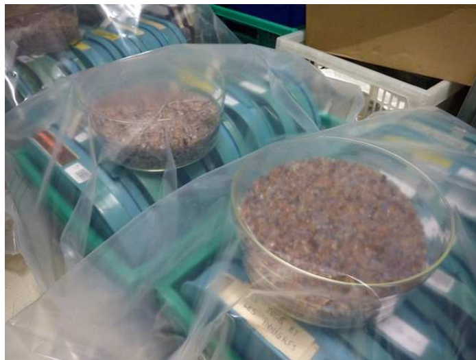
Fig. 23 en 24: Het drogen van ‘moeilijke’ videobanden bij AktiveArchive. (foto: PACKED vzw)
