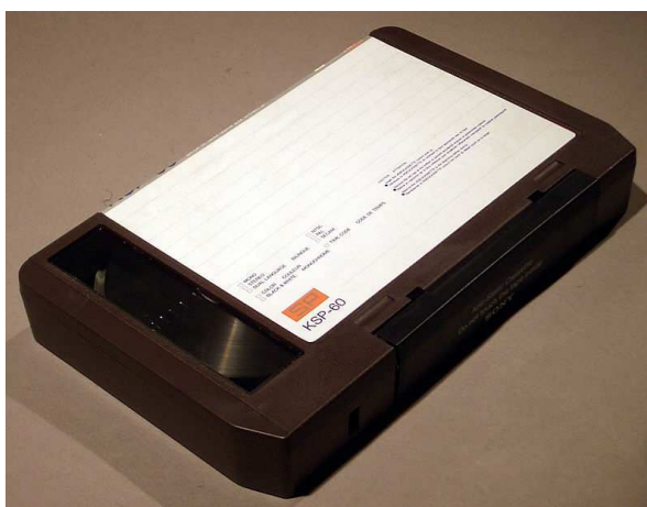
Fig. 13: Een 3/4" U-matic tape (bron: Wikimedia Commons).
