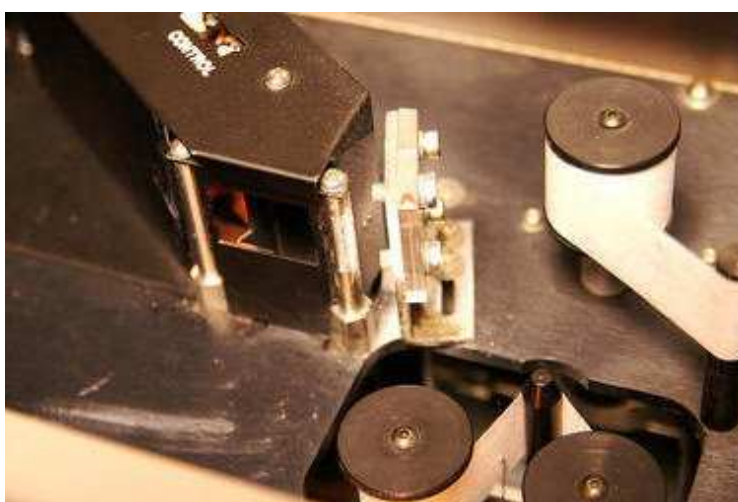
Fig. 20 en 21: Het reinigingspapier en de messen van de RTI-reinigingsmachine bij INA (foto's: clubic.com).
