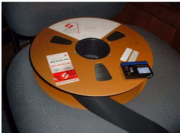
Fig. 12: Een analoge Quadruplex 2 inch tape (samen met een digitale MiniDV-cassette (bron: Wikimedia Commons).
