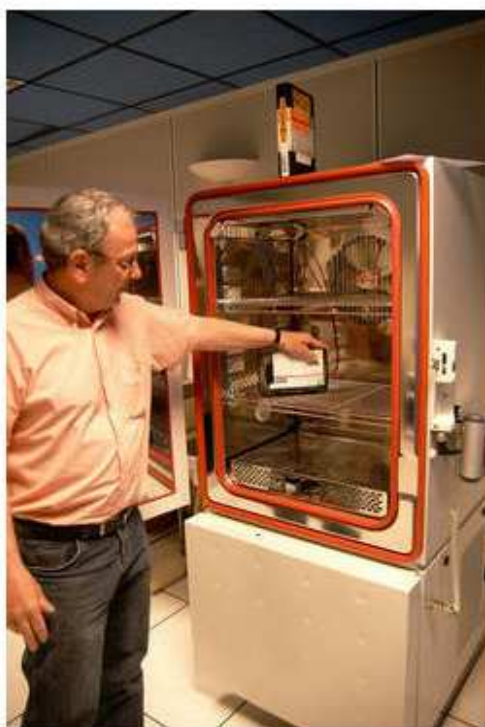
Fig. 22: De oven die bij INA wordt gebruikt om de ‘moeilijke’ videobanden te ‘bakken’ (foto: clubic.com).
